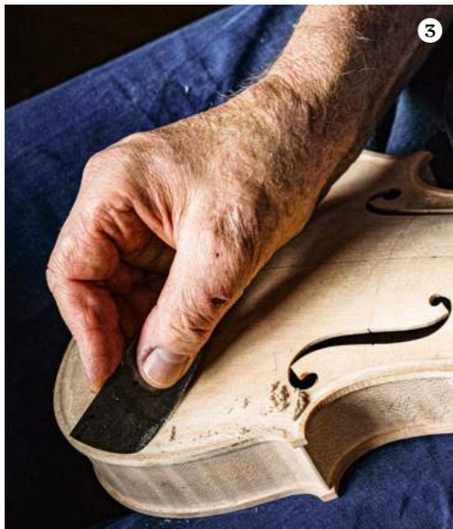
3+4 Schaben und hören Filigrane Arbeit für den perfekten Klang
