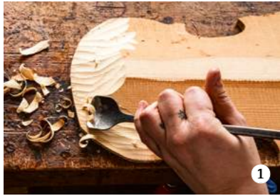
1+2 Stemmeisen und Minihobel Span um Span auf die richtige Stärke
