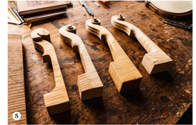
5 Schnecke Auch als Volute bekannt und oft kunstvoll gearbeitet. Für den Klang aber deutlich weniger wichtig als der Steg aus Spiegelahorn
